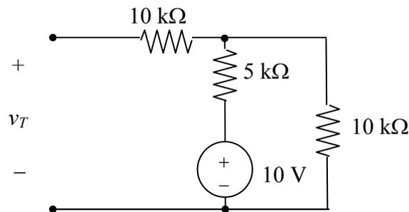
La tensione  $v_T$  coincide con la tensione ai capi del resistore a destra:  $v_T = 10 \frac{10k}{15k} = \frac{20}{3}$  V. La
