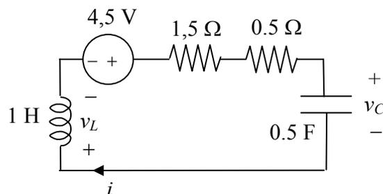
È un circuito RLC serie con  $\alpha = \frac{R}{2L} = 1$ ,  $\omega_0 = \frac{1}{\sqrt{LC}} = \sqrt{2}$ . Il circuito è sottosmorzato ( $\alpha < \omega_0$ ).
