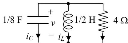
Con la LKC si scrive:  $i_C(0^+) + i_L(0^+) + v(0^+)/4 = 0 \Rightarrow i_C(0^+) = -i_L(0^+) = -3 \text{ A}$  (la corrente dell'induttore è continua). Infine  $\frac{dv}{dt}(0^+) = -24$ .
