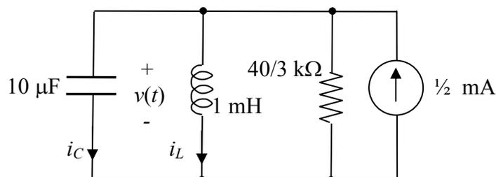
Utilizzando il procedimento descritto alle pagine 269-270, si ottiene una equazione differenziale della forma (8.6) con  $\alpha = \frac{1}{2RC} = \frac{15}{4} = 3,75$  e  $\omega_0 = \frac{1}{\sqrt{LC}} = 10^4$ . Poiché  $\alpha < \omega_0$ , il circuito è sottosmorzato, con pulsazione  $\beta = \sqrt{\omega_0^2 - \alpha^2} \cong 10^4$  rad/s.
