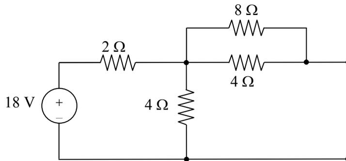
Utilizzando il bipolo equivalente di Thevenin abbiamo il circuito seguente in  $t = 0^-$ . Si ricavano i seguenti valori:  $i_L(0^-) = 1$  A,  $v_C(0^-) = 12 \frac{8}{12} = 8$  V.
