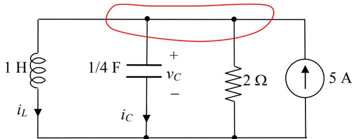
È un circuito RLC parallelo con un generatore costante. La tensione  $v_C$  è descritta da una equazione differenziale del 2° ordine con  $\alpha = \frac{1}{2RC} = 1$ ,  $\omega_0 = \frac{1}{\sqrt{LC}} = 2$ . Poiché  $\alpha < \omega_0$  il circuito è
