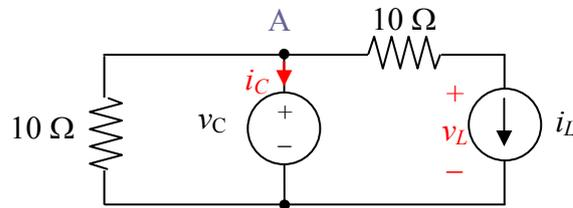
LKC nodo A:  $\frac{v_C}{10} + i_C + i_L = 0 \quad \Rightarrow \quad i_C = -0,1v_C - i_L$
