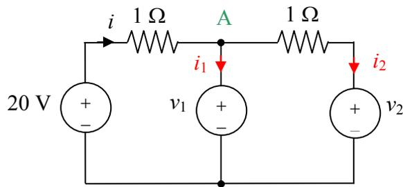
Con la LKT si ottiene:  $i = 20 - v_1$   $i_2 = v_1 - v_2$
