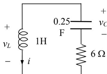
Con la LKT si scrive:  $v_L(0^+) + 6i(0^+) - v_C(0^+) = 0 \Rightarrow v_L(0^+) = v_C(0^+) = 12 \text{ V}$  (la tensione del condensatore è continua). Infine  $\frac{di}{dt}(0^+) = 12$ .
