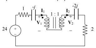
Inoltre, poiché  $\mathbf{V}_1 = \mathbf{V}_2$ , il trasformatore può essere sostituito da un corto circuito.
