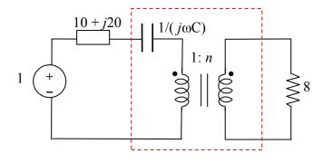
La potenza massima si ricava con la formula  $P_{\text{max}} = \frac{V_s^2}{8R_s} = \frac{1}{80} = 0,0125 \text{ W}.$
