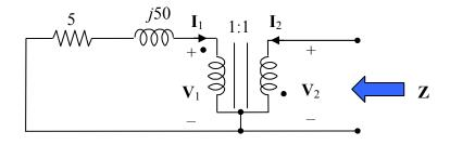
Poiché il carico è resistivo il teorema del massimo trasferimento di potenza non è applicabile. Ricaviamo la potenza media in funzione di *R* e troviamo il massimo annullando la derivata. Riportando il circuito al secondario si ottiene lo schema seguente.
