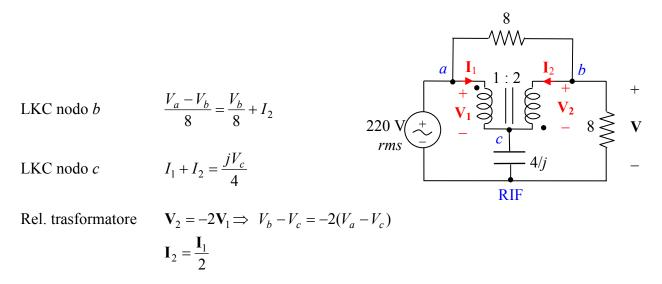
Dalla prima relazione del trasformatore si ricava  $V_c = (V_b + 440)/3$ ; sostituendo  $V_c$  e  $I_1$  nelle equazioni LKC e ponendo  $V_a = 220$ , si ottiene il sistema seguente:
