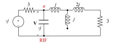
L'induttore verticale non è percorso da corrente dunque gli induttori accoppiati equivalgono ad un semplice induttore di impedenza 3j. Si ricava la tensione V quindi si procede come sopra.
