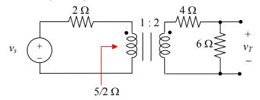
Per ottenere la resistenza equivalente si spegne il generatore (figura seguente). La resistenza vista tra i morsetti del secondario è  $2n^2 = 8 \Omega$ . La resistenza equivalente è  $R_T = 12//6 = 4 \Omega$ .
