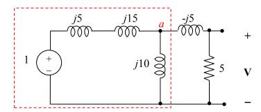
Applicando il teorema di Thevenin al bipolo nel riquadro si ottiene un partitore di tensione,
