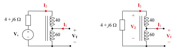
Per determinare l'impedenza equivalente ricaviamo prima il rapporto di trasformazione:
